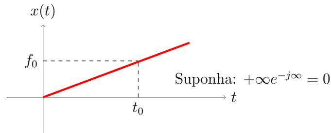
**Solução:** O modelo do sinal é um modelo linear do tipo  $x(t) = at + b$ . Como o sinal passa pela origem, podemos dizer que  $b = 0$ . Sendo assim, podemos dizer que o modelo do sinal se torna:
